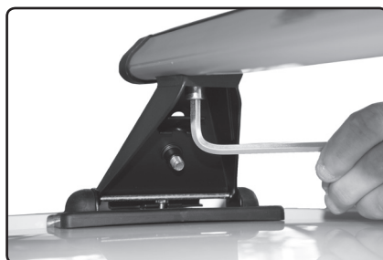
Překontrolujte pevné utažení šroubů M8x18 příloženým klíčem (imbus č.6). Rozteč šroubů M8x18 s imbusovou hlavou, které fixují patku nosiče k tyči by měla odpovídat rozteči „D“ uvedené v tabulce na titulní straně.
