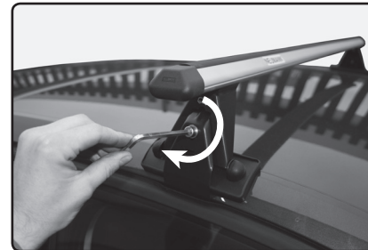
Pevně utáhněte šroub M8x35 příloženým klíčem (imbus č.6) rovnoměrně na obou stranách nosníku. Šroub neutahujte nadměrnou silou, aby nedošlo k deformaci bočního úchyty a špatnému upevnění nosiče.
